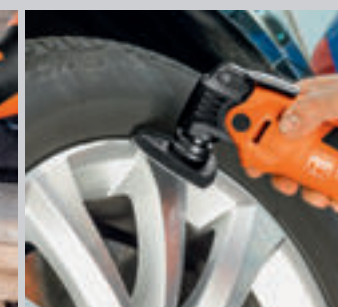
Specjalny papier ścierny o bardzo drobnej ziarnistości nadaje się perfekcyjnie do wyprawk lakierniczych i usuwania ubytków.
