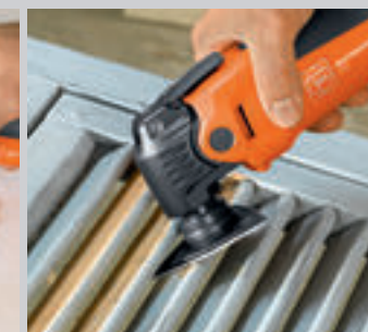
Płaska płytka ścierna do trudno dostępnych przestrzeni.
