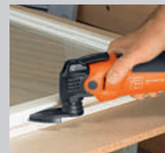
Trzpień szlifierski do użytkowania w wąskich miejscach.
